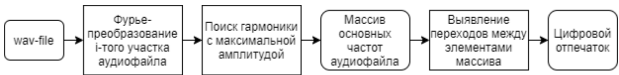
Рис. 2. Алгоритм формирования вектора признаков для получения цифровых отпечатков аудиофайлов из работы [14].
