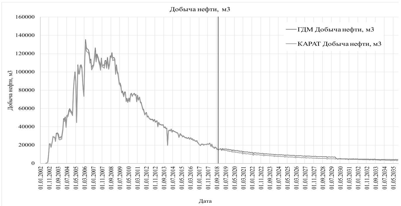
Рис. 6. Сравнение прогнозов добычи нефти, рассчитанных с помощью симулятора tNavigator и инструмента КАРАТ
