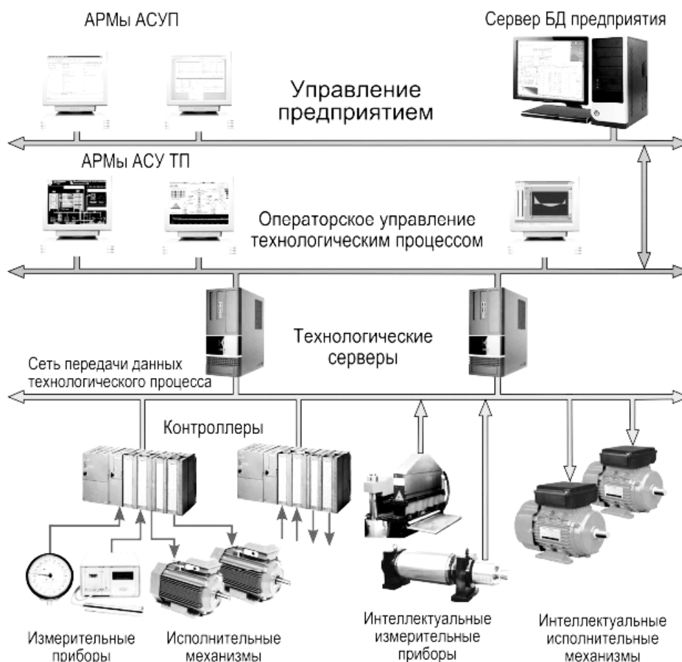
Рис. 1. Структура современной промышленной системы автоматизированного сбора данных и управления [6]
