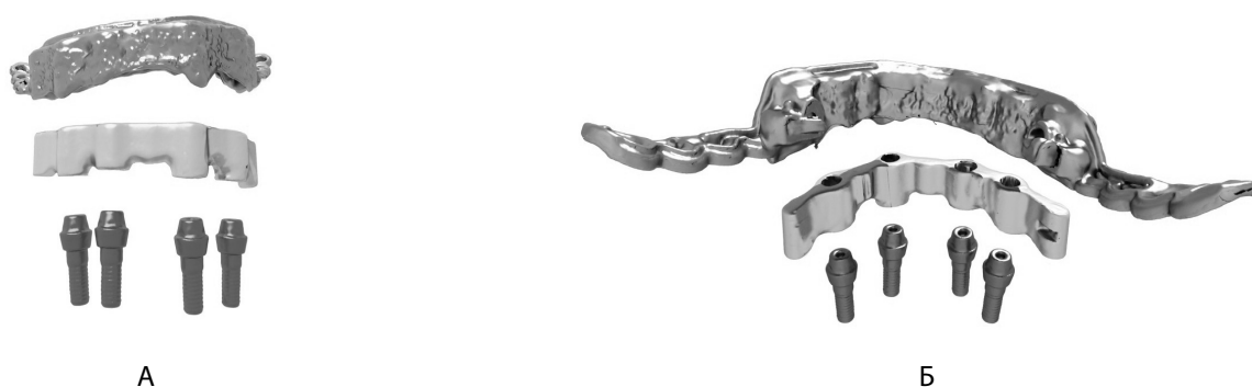
Рис. 2. Трехмерная модель первичной балки и вторичного каркаса на дентальных имплантатах: А-вид спереди, Б-вид сзади.
