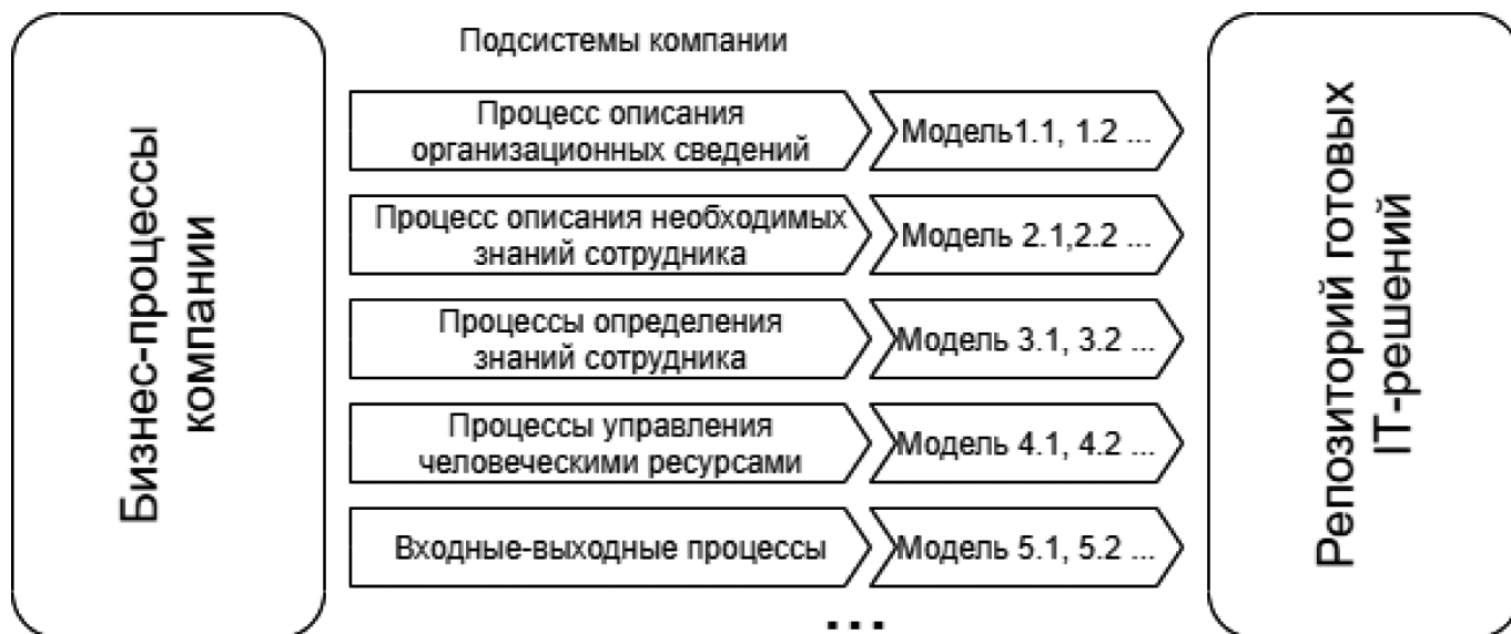
Рис. 5. Структурная схема формирования репозитория моделей ключевых информационных процессов компании
