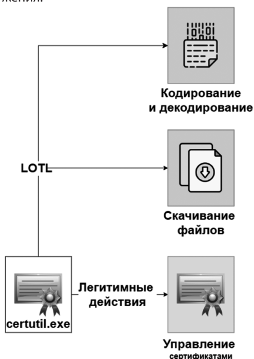
Рис. 3. Легитимная функциональность утилиты certutil.exe и функциональность LOTL-техник
