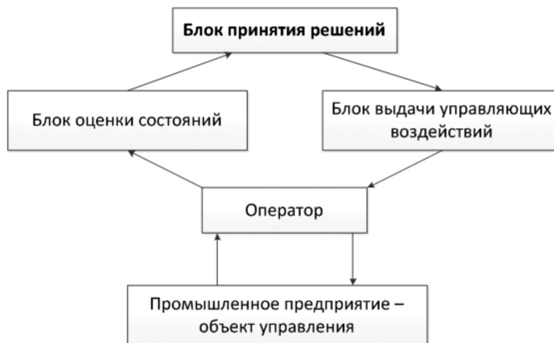
Рис.1. Архитектура системы поддержки принятия решений с нечеткой логикой для функционирования промышленных предприятий.
