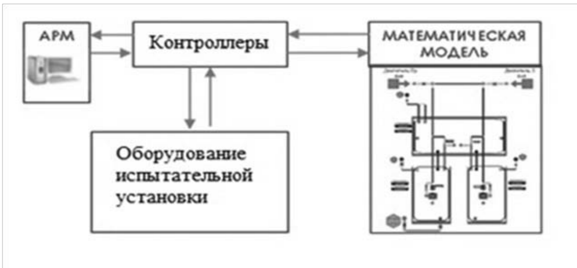
Рис. 2. Взаимосвязь математической модели и испытательной установки
