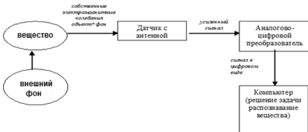
Рис. 1. Обобщённая структура системы записи и распознавания информационных образов
