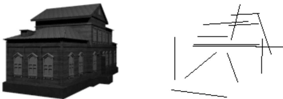
Рис. 2. Извлечение из изображения прямолинейных отрезков
