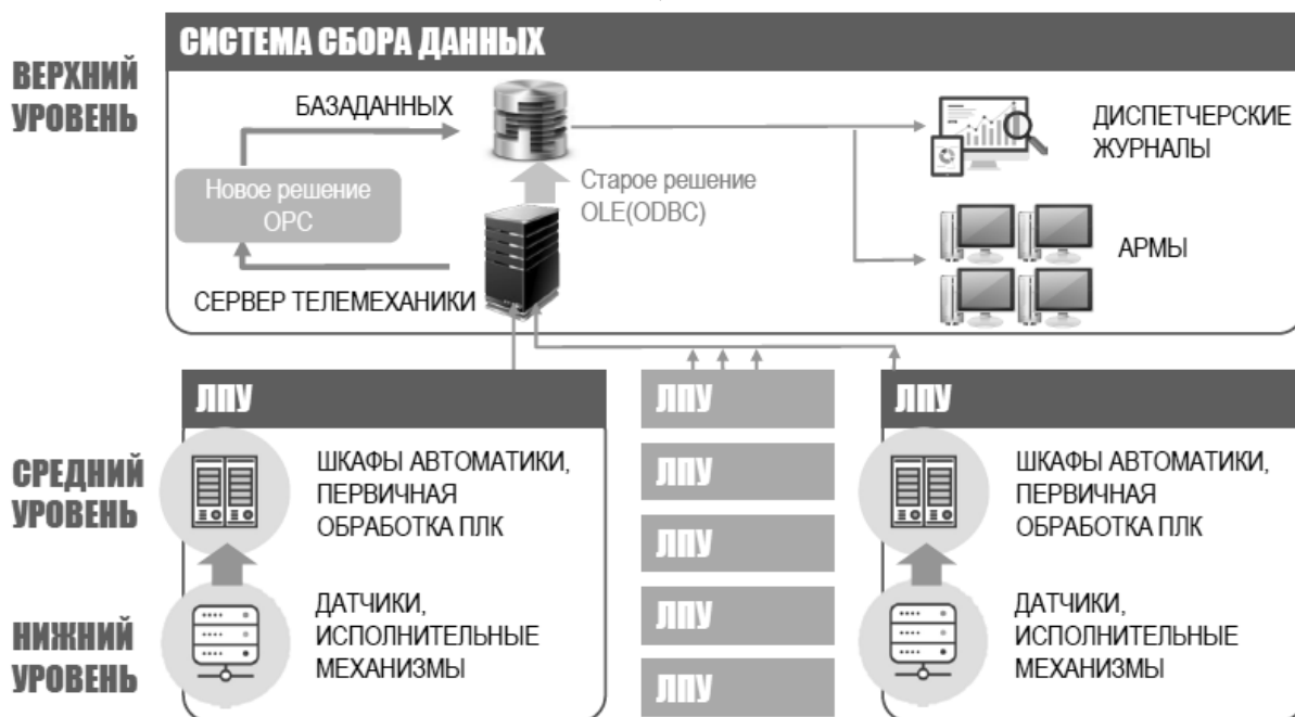
Рис. 1. Схема АСУ ТП ООО «Газпром трансгаз Томск»
