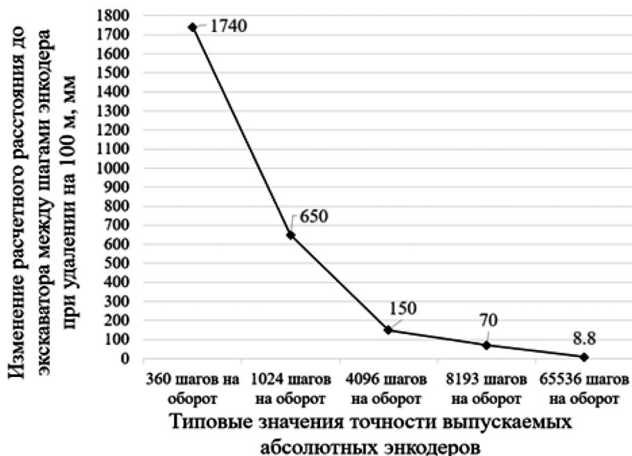
Рис. 7. Зависимость изменения расчетного размера отрезка АВ на один шаг у энкодеров с разным соотношением шагов/оборотов на расстоянии 100 метров до экскаватора
