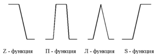
Рисунок 2. Типы стандартных функций принадлежности.
