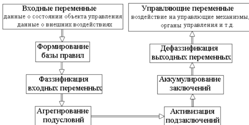
Рисунок 1. Схема нечёткого вывода в нечётких системах автоматического управления.
