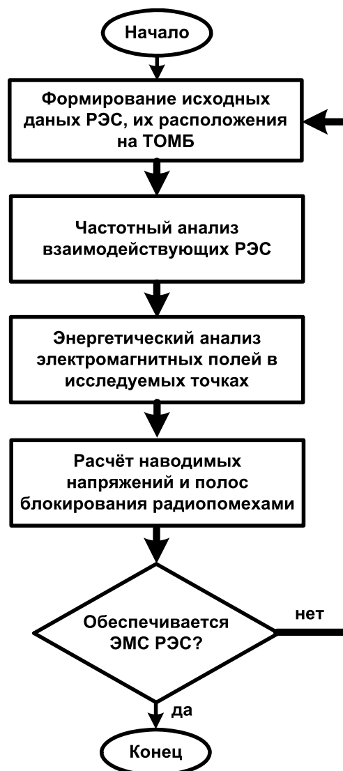
Рис. 5. Укрупнённая структура алгоритма программной реализации методики расчёта ЭМС РЭС.
