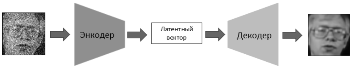
Рис. 1. Функционирование автоэнкодера по шумоподавлению изображения.
