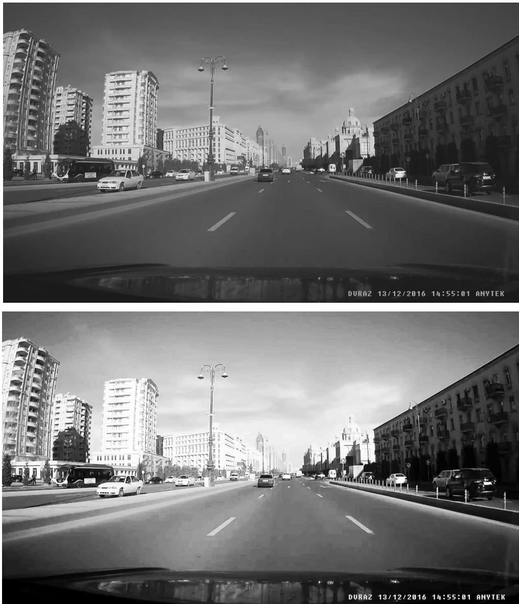
Рис. 12. (а) Изображение низкой контрастности ( CL=32 ) в режиме grayscale (б) Изображение с примененным к нему фильтром гистограммного выравнивания ( CL=67 )
