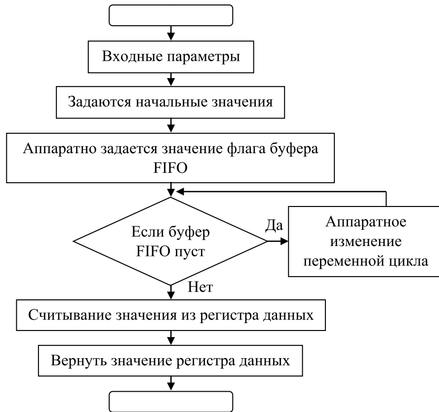
Рис. 2. Блок-схема для функции чтения одного байта из Flash-памяти
