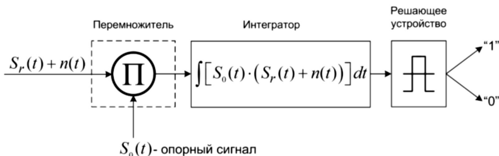
Рисунок 2. Корреляционный приемник для КСШП сигнала.
