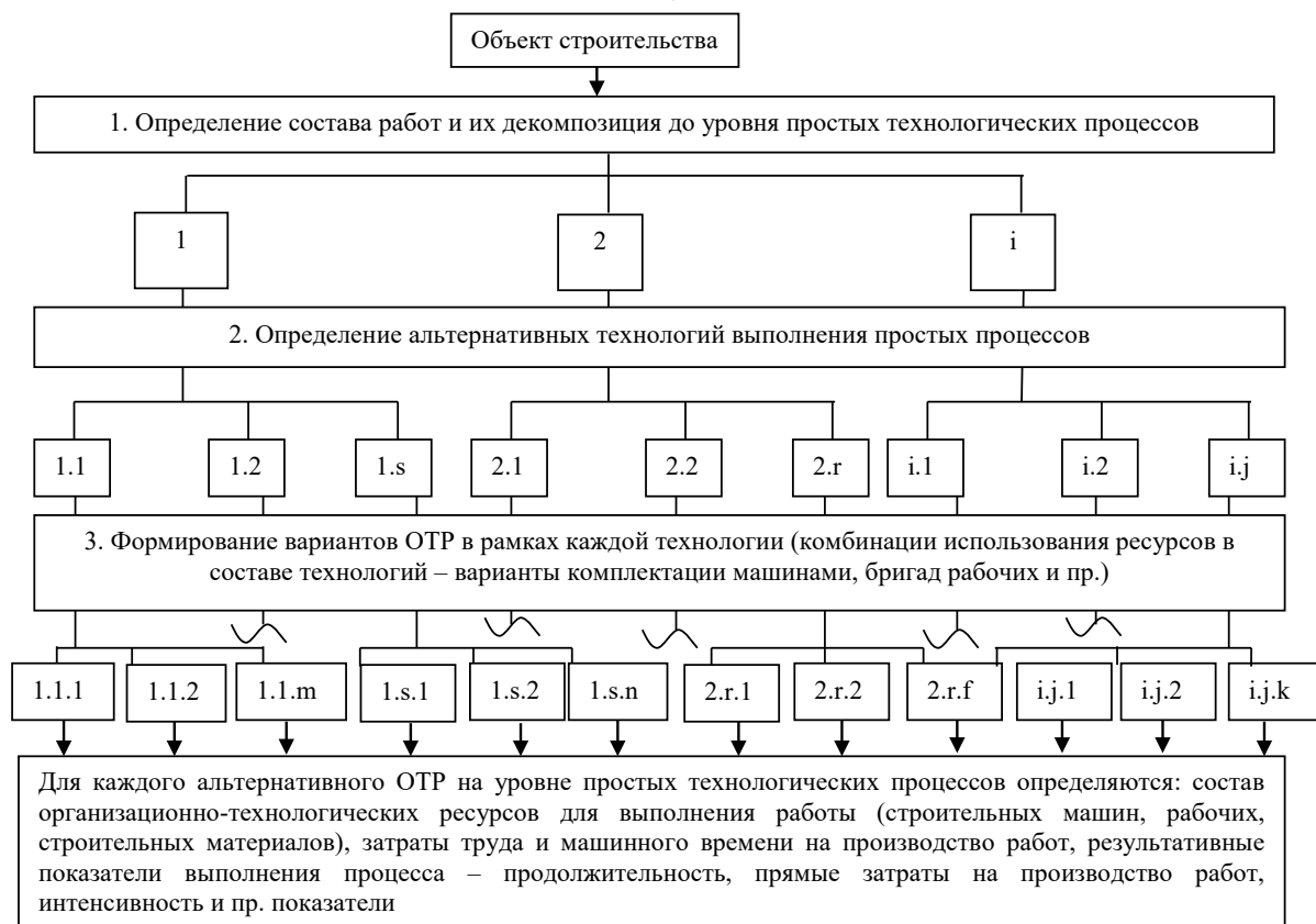
Рис. 1. Принципиальная схема реализации комбинаторного подхода в части генерации альтернативных вариантов выполнения простых технологических процессов
