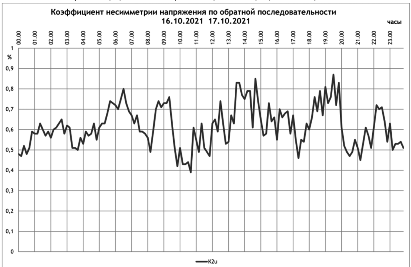
Рис. 2. Суточный график изменения коэффициента несимметрии напряжений по обратной последовательности в трехфазной электрической сети
